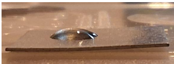
شکل ۵. رفتار آبدوستی قطره آب بر روی زیرلایه تیتانیوم
