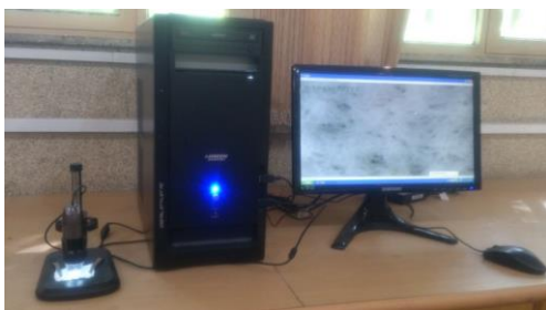
شکل ۱۸. چیدمان سیستم تصویر برداری از قارچ ها.
