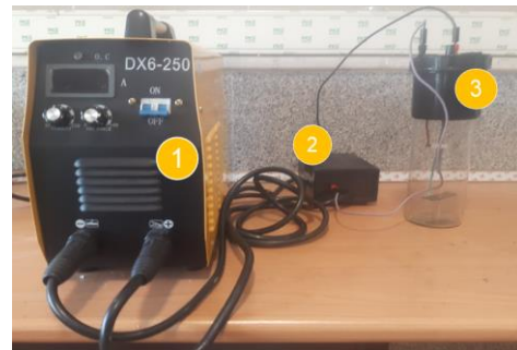
شکل ۲. دستگاه انفجار الکتریکی سیم. (۱) جوش اینورتر، (۲) مدار تقویت کننده جریان، (۳) مخزن انفجار.
