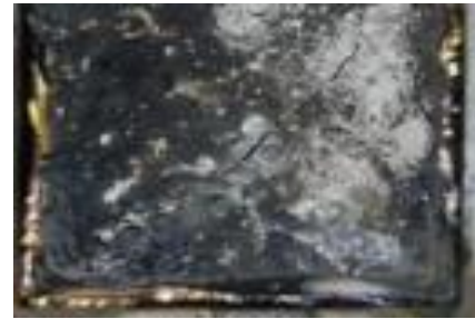
شکل ۱۴. تصویر ذغال باقیمانده نانو کامپوزیت حاوی نانو هالوزیت، پلی فسفوژن و هیدروکسید آهن
