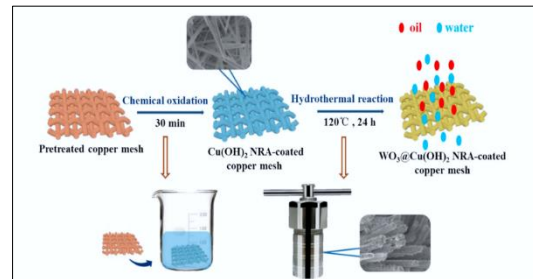
شکل ۲-۸) شماتیک یک فرآیند ساخت دو مرحله‌ای مش‌های مسی پوشش‌داده‌شده با نانومیله‌های WO 3 @Cu(OH) 2 با ترکیبی از روش‌های اکسیداسیون شیمیایی و رسوب هیدروترمال [۶۸]
