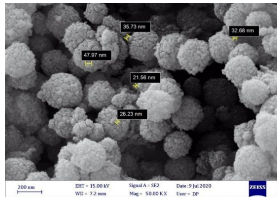
شکل ۵- تصویر SEM نانوکاتالیزگر مغناطیسی هسته-پوسته \text{Fe}_3\text{O}_4@C\text{-ONa}
