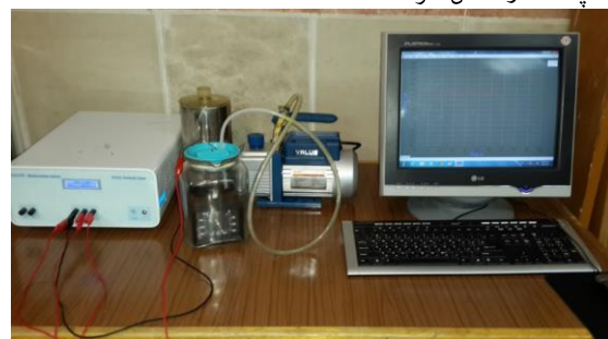
شکل ۲. مجموعه تجهیزات به‌کار رفته برای بررسی عملکرد حسگر رطوبت
