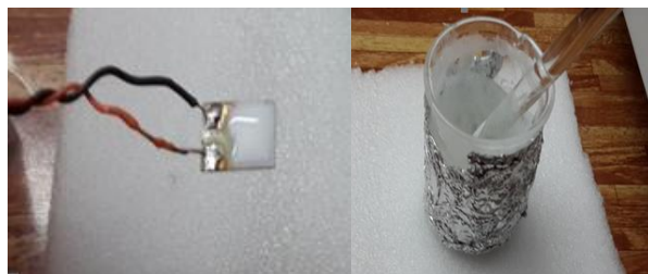
شکل ۱. تصویر نانوذرات آناتاز دی‌اکسید تیتانیوم (الف) نانوذرات سنتز شده و خمیر دی‌اکسید تیتانیوم تهیه شده (ب) خمیر دی‌اکسید تیتانیوم لایه‌نشانی شده بر روی الکتروود شانه‌ای
