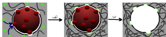
شکل ۱. مکانیسم قالب‌گیری: (آ) وقتی بسیار در حضور الگو ساخته می‌شود، دو عمل هم زمان اتفاق می‌افتد. ابتدا، گروه‌های عاملی در الیگومر (سبز) به سمت گروه‌های عاملی در الگو که می‌توانند با آن‌ها برهم‌کنش داشته باشند، جهت‌گیری می‌کنند (دایره‌های قرمز). دوم، زنجیرهای بسیاری (خطوط خاکستری) به وجود می‌آیند و اتصال عرضی می‌دهند. (ب) وقتی الگو حذف می‌شود سایت‌های پیوندی به شکل خود باقی می‌مانند [۱]
