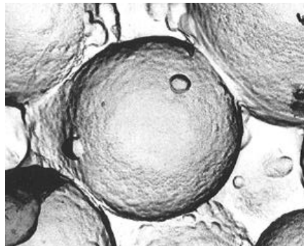
شکل ۲- میکروگراف الکترونی از ذرات کروی توخالی با قطری معادل ۸۰۰-۱۰۰۰ nm و دیواره‌هایی با ضخامت ۵۰ nm حاوی رزین‌های بسیاری که در اطراف نانوحباب متان در دریاچه‌ی کیو در آفریقای شرقی تشکیل شده است [۱۳].
