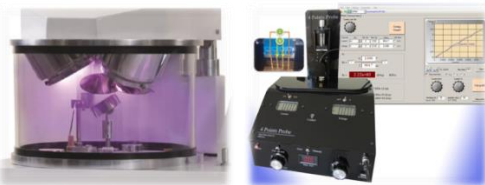
شکل ۲: دستگاه اسپاترینگ (سمت چپ) و دستگاه مقاومت سنج ۴ پراب (سمت راست) که در این پروژه استفاده شده است.
