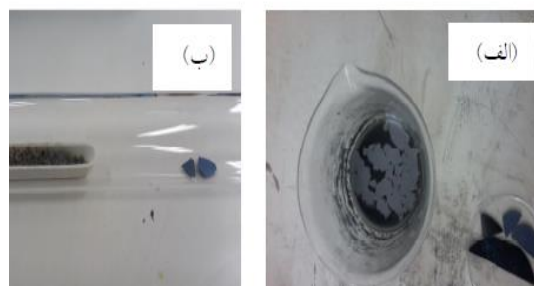
شکل ۱. (الف) نانو صفحات دوبعدی دی‌سولفید مولیبدن در محلول، (ب) لوله کوارتز حامل بوته زیر لایه SiO_2
