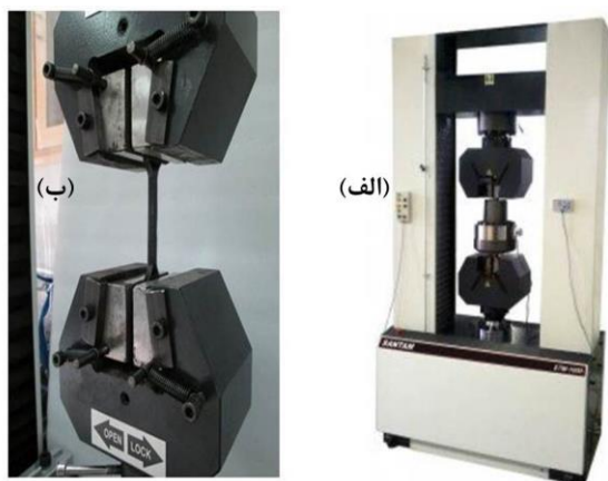
شکل ۳. (الف) شمایی از دستگاه سنتام با فک‌های آزمون کشش، (ب) نمونه تحت آزمایش.
