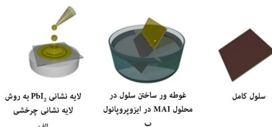
شکل ۲. روش لایه‌نشانی پروسکایت به روش غوطه‌وری
