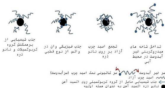
شکل ۱. مکانیسم‌های متفاوت فرآیند جذب روی نانو ذره اکسید آهن
