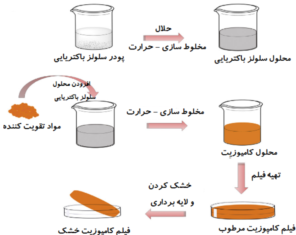
شکل ۱۰- طرح کلی تولید کامپوزیت سلولز باکتریایی از انحلال سلولز باکتریایی [26] در تحقیق دیگری ویژگی‌های مکانیکی ورقه‌های سلولز باکتریایی ساخته شده با پرس داغ شامل میانگین مقاومت کششی نهایی، حداکثر ازدیاد طول و مدول یانگ به ترتیب 241/42 \pm 21/86 مگاپاسکال، 8/21 \pm 3/01 % و 6/86 \pm 0/32 گیگاپاسکال گزارش شده است [21]. همچنین در تحقیق گوهادوس و همکاران (۲۰۰۵)، مقدار مدول یانگ برای نانوالیاف سلولز باکتریایی با قطر بین ۳۵ تا ۹۰ نانومتر، 78 \pm 17 گیگاپاسکال گزارش شده است [30].
