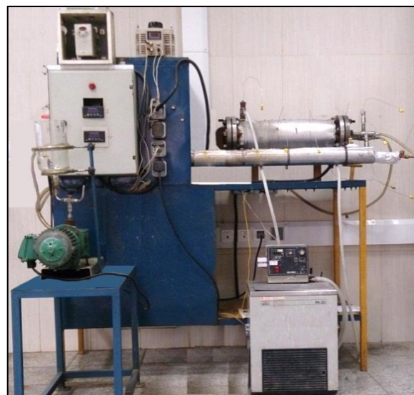
شکل ۹: سیستم آزمایشگاهی برای اندازه‌گیری ضریب انتقال حرارت جابجایی
