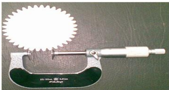
شکل (۲) اندازه گیری span-size با میکرومتر فک بشقابی
