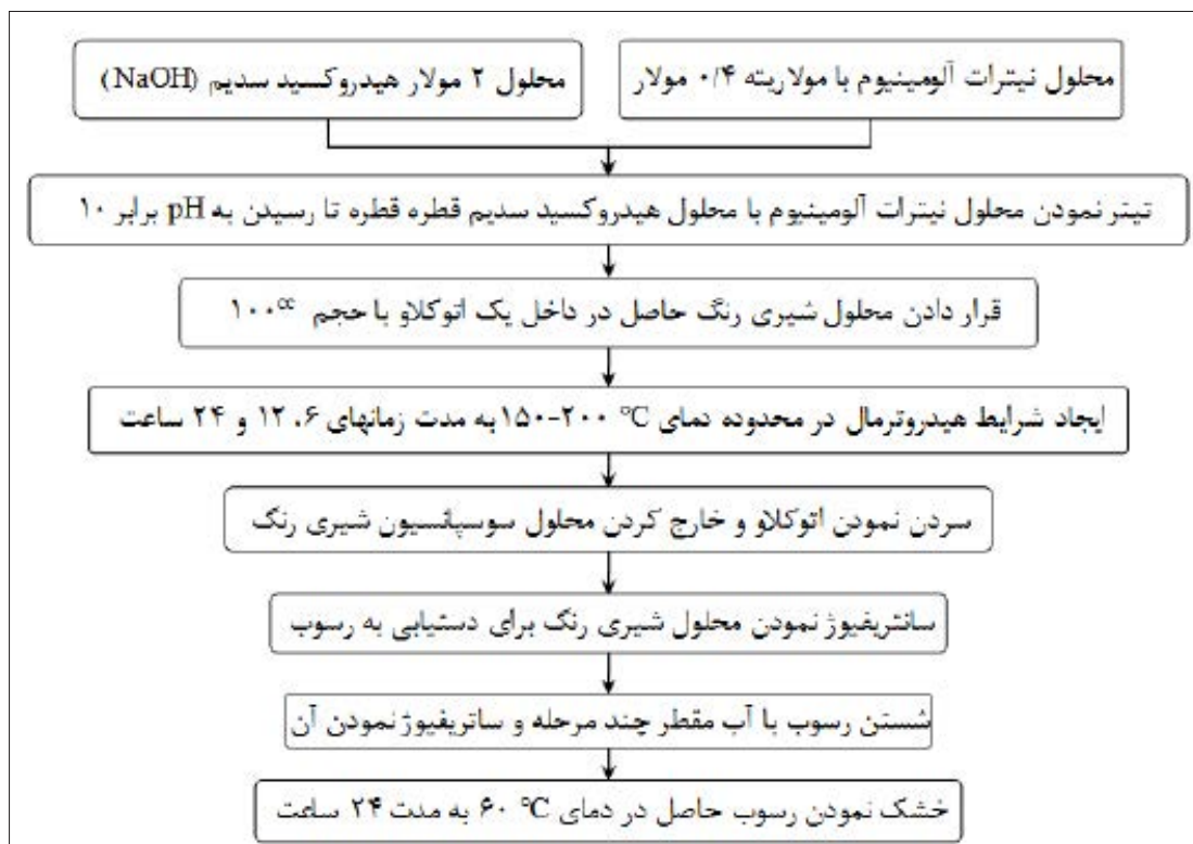
شکل ۳: نمونه طرحواره سنتز بوهیمیت با استفاده از روش هیدروترمال برای سنتز نانو ساختارهای بوهیمیت [۴۳]
