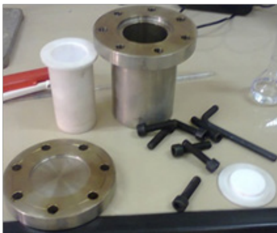
شکل ۲: تصویری از راکتور (اتوکلاو) مورد استفاده در روش هیدروترمال [۲۹].
