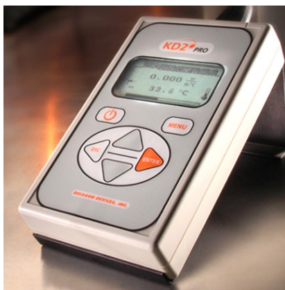
شکل ۱: نمائی از دستگاه اندازه گیری تجربی ضریب هدایت حرارتی نانوسیالات KD2-
