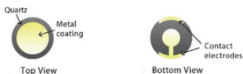
شکل ۱. ساختار یک کریستال کوارتز به همراه الکترودها از نمای بالا و پایین کریستال [۸]
