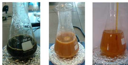
شکل ۷) الف - عصاره حاصل از گیاه بومادران ب - نانو ذرات در حال تشکیل ج - نانو ذرات تشکیل شده به کمک عصاره گیاه
