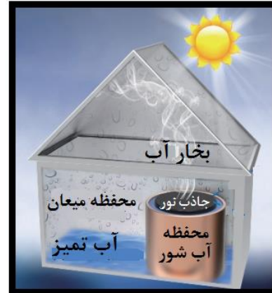
شکل ۱- نمایی از فرایند تولید آب شیرین در یک سیستم تبخیر بخار خورشیدی [۱].
